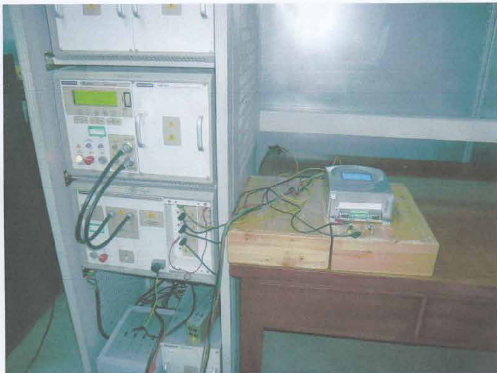
图 1: 振荡波抗扰度检验配置图
