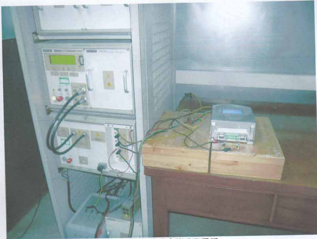
图 5: 浪涌抗扰度检验配置图
